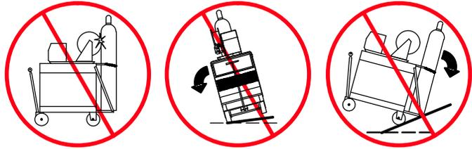
**⚠** No coloque el alimentador donde el alambre para soldadura podría tocar el cilindro.
